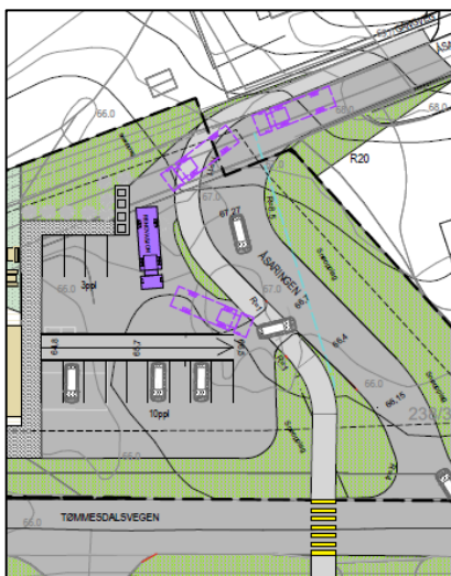
Fig 4 viser manøvrering av renovasjonsbil
